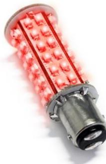
Questa lampadina grazie all'elettronica integrata è in grado di sostituire le comuni lampadine a incandescenza a 12 e 24 Volt alimentate in continua. L'attacco BAY15D è spesso utilizzato nella luce di fonda e nelle luci di navigazione. Questo tipo di attacco a baionetta presenta i due "piedini" laterali di fissaggio a un'altezza differente e due poli per l'alimentazione. Le sue caratteristiche principali sono:
