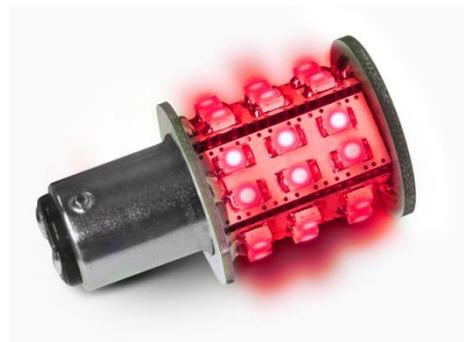
Questa lampadina grazie all'elettronica integrata è in grado di sostituire le comuni lampadine a incandescenza a 12 e 24 Volt alimentate in continua. L'attacco BAY15D è spesso utilizzato nella luce di fonda e nelle luci di navigazione. Questo tipo di attacco a baionetta presenta i due "piedini" laterali di fissaggio a un'altezza differente e due poli per l'alimentazione. Le sue caratteristiche principali sono:
