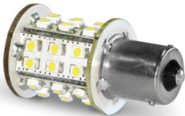
Questa lampadina grazie all'elettronica integrata è in grado di sostituire le comuni lampadine a incandescenza a 12 e 24 Volt alimentate in continua. L'attacco BA15S è spesso utilizzato nella luce di fonda e nelle luci di navigazione. Questo tipo di attacco a baionetta presenta i due "piedini" laterali di fissaggio sullo stesso piano orizzontale. Il polo d'alimentazione positivo è situato sulla parte inferiore mentre il negativo è collegato direttamente alla camicia dell'attacco.
