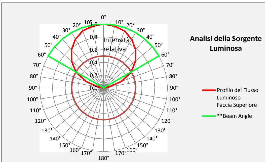
\*\* Il Beam Angle è l'angolo compreso tra gli assi per i quali il valore dell'intensità luminosa vale la metà della massima intensità luminosa
