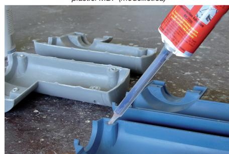
*Incollaggio di gusci di poliestere (prototipi di stampi)*
