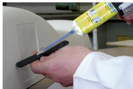
*Incollaggio di una stecca metallica ad un coperchio di poliestere in una macchina agricola*
