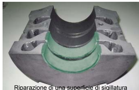
Riparazione di una superficie di sigillatura
