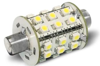
Questa lampadina grazie all'elettronica integrata è in grado di sostituire le comuni lampadine alogene a bulbo a 12 e 24 Volt alimentate in continua. La linea "SV8.5 Barrel End" Dixplay permette una completa sostituibilità Plug&Play con gli attacchi FESTOON da 42 mm. Questa tipologia di attacco si trova spesso installata su imbarcazioni di fabbricazione francese che montano plafoniere aquasignal.. Disponibili a 6, 9 e 30 LED. Questo prodotto permette un'illuminazione a 360°.
