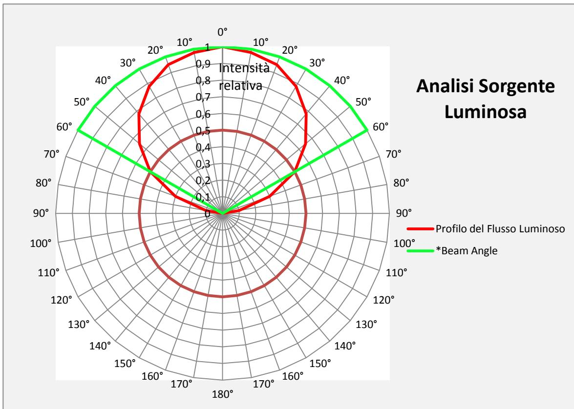
\* Il Beam Angle è l'angolo compreso tra gli assi per i quali il valore dell'intensità luminosa vale la metà della massima intensità luminosa
